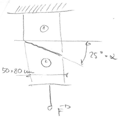
Dva materiály jsou slepeny podél hrany nakloněnou pod úhlem  $\alpha = 25^\circ$  vzhledem k vodorovné rovině. Lepidlo snese maximálně  $\sigma = 800 \text{ kPa}$  a  $\tau = 600 \text{ kPa}$  zároveň, stanovte sílu  $F$ .
